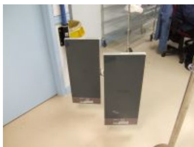
Figura1.11. Două readere pe latura unei porți de acces.
